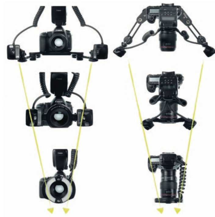
Fig. 44 L'illustration met en évidence la flexibilité des flash déportés montés sur des bras angulés contre celle d'un flash annulaire.
