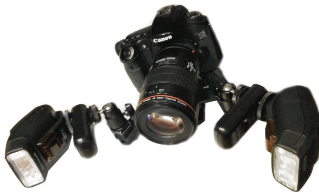
Fig. 25 Montage de flashes déportés à partir de pièces achetées indépendamment sur internet
