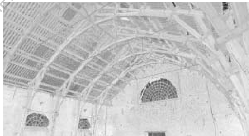
Figure 18: Nuage de points intérieur issue d'un scanner 3D - source : http://www.life3d.fr/
