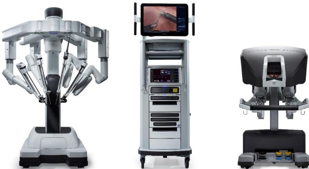
Figure 2.1 : da Vinci® Xi™ Surgical System, de gauche à droite : le chariot patient, le système de vision et la console de commande.
