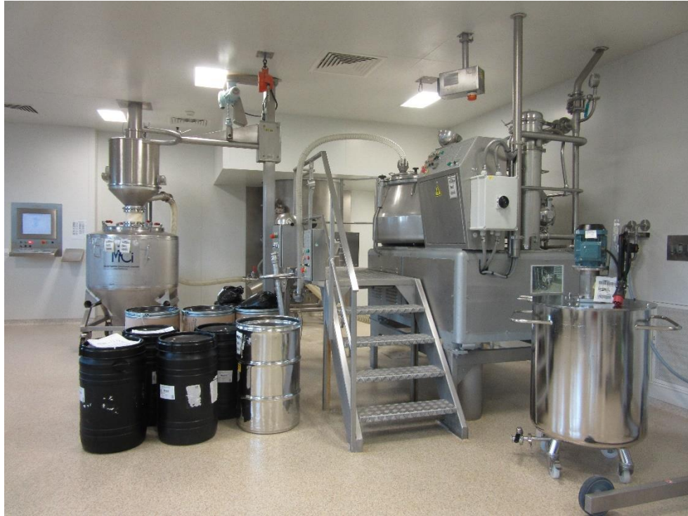
Figure 7 : Salle avec quelques équipements de granulation par voie humide
