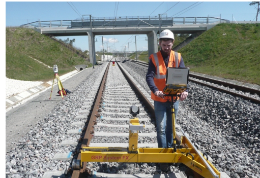
Figure 17 : Levé profil au chariot – LGV SEA (source C Bury)
