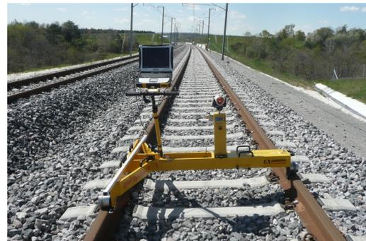
Figure 20: Chariot de mesure (source : C BURY)
