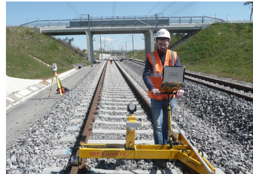
Figure 17 : Levé profil au chariot – LGV SEA (source C Bury)
