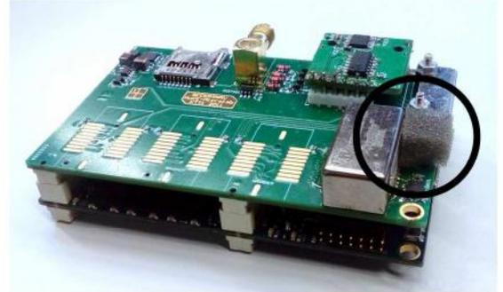
Illustration 8 : Système électronique avec mousse accolée (normalement avec scotch) à l'IMU et au capteur de pression
