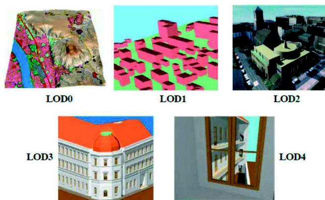
Figure 11 : Les niveaux de détails de CityGML (Celnik & Lebègue, 2015)
