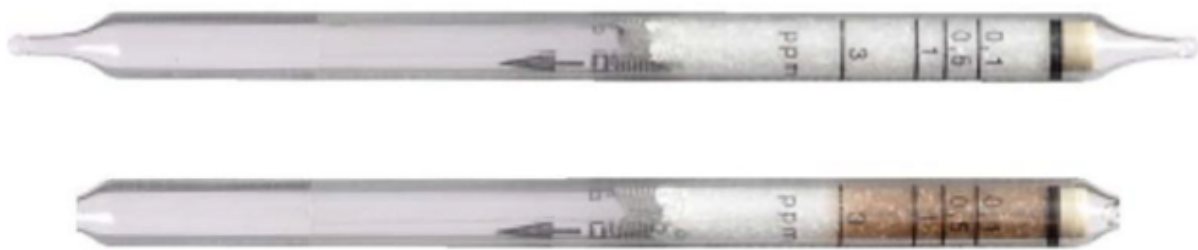
Figure 16 : 2 capteurs Dräger détectant la concentration de peroxyde d'hydrogène (47)
