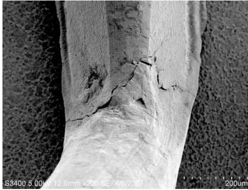
Figure 15 : Fissure du talon du fil en aluminium d'un module à MOSFET après 29 760 cycles de température ( I_0 = 150 A, T_c = 90 °C, T_{j(max)} = 170 °C, T_{ON} = 10 s, T_{OFF} = 20 s) [12]
