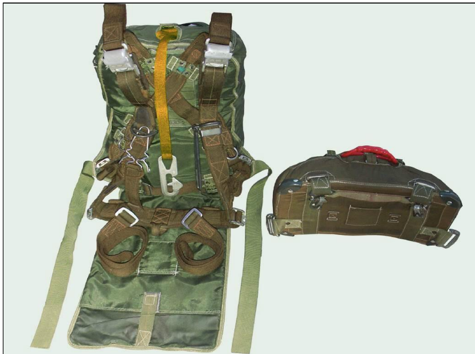
Image 2 : EPI composé des parachutes TAP 696-26 (à gauche) et 511 (à droite), vue de dos.
