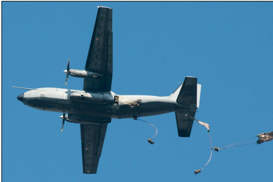
Image 10 : Sortie d'avion, extraction des suspentes du sac.
