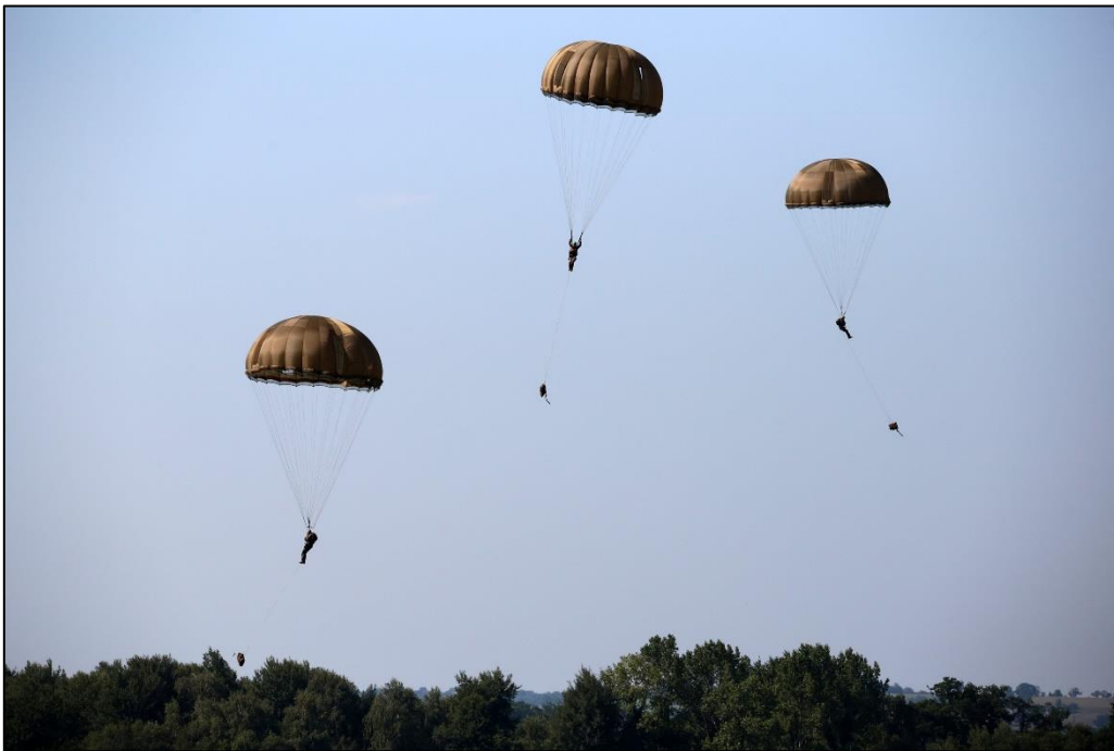
Image 12 : saut en EPI avec gaine. La gaine est ici libérée, suspendue par une corde, 20 m sous le parachutiste.
