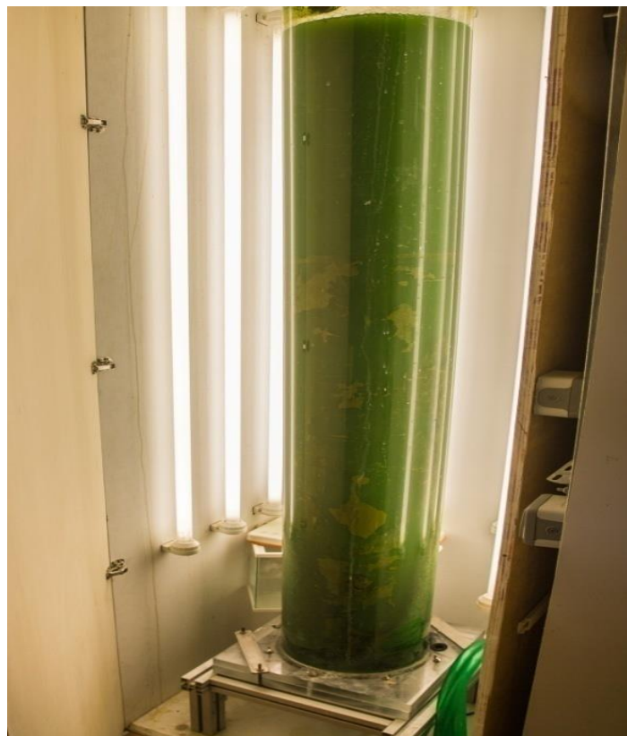
Figure 8 : Photobioréacteur contenant une souche de spiruline originaire du Burkina Faso (photo de l'auteur - octobre 2017).
