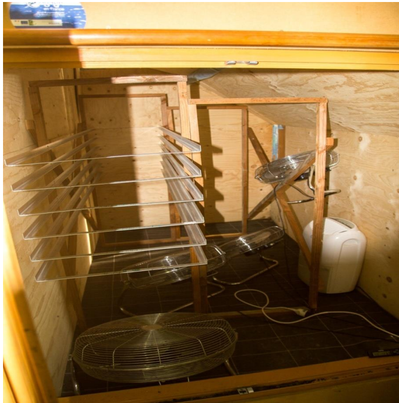
Figure 17 : Armoire ventilée permettant le séchage de la spiruline (photo de l'auteur - octobre 2017).
