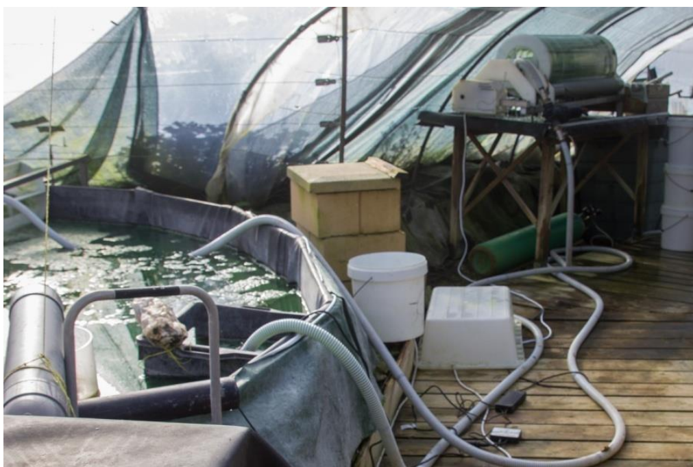
Figure 11 : Système d'aspiration de la spiruline au travers d'une pompe (photo de l'auteur - octobre 2017).
