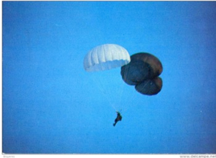
Figure 19 : Double coupole avec parachute de secours (en blanc) ouvert.
