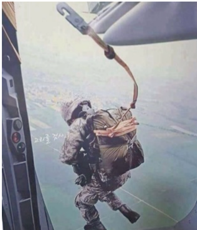
Figure 18 : Incident majeur à la sortie de l'avion, SOA non accroché au câble de l'aéronef
