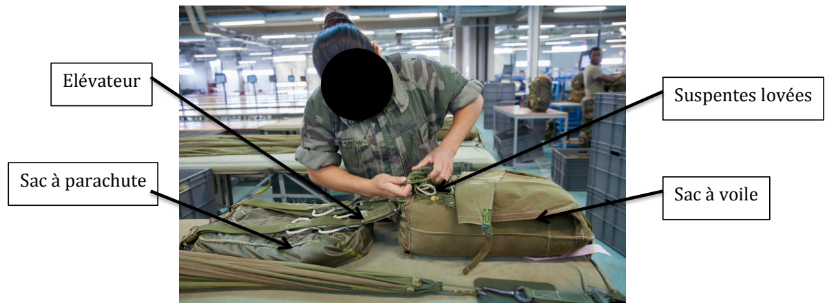
Figure 3 : Parachute dorsal en cours de pliage
