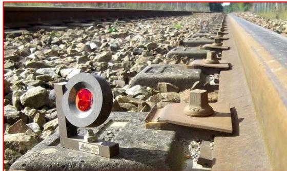
Figure 15 : Suivi automatisé des mouvements altimétriques de rails SNCF (Système auscultation automatisée) Source : <http://www.auscultation-automatique.fr/> consulté le 08/05/2016.
