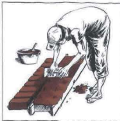
UN MOULE EN BOIS AVEC UNE OU PLUSIEURS ALVÈRES EST REMPLI AVEC LE MÉLANGE.
