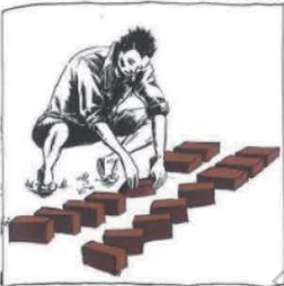
APRÈS QUELQUES JOURS, LES BRIQUES SONT MANIPULABLES SANS DÉFORMATION. ELLES SONT POSITIONNÉES SUR LA TRANCHE POUR UN SÉCHAGE HOMOGENE.
