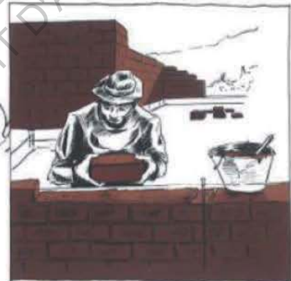
LES ADOBES SONT MAÇONNÉES À L'AIDE D'UN MORTIER DE TERRE SUR UN SOUBASSEMENT (PIERRES, BRIQUES DE TERRE CUITE...)
