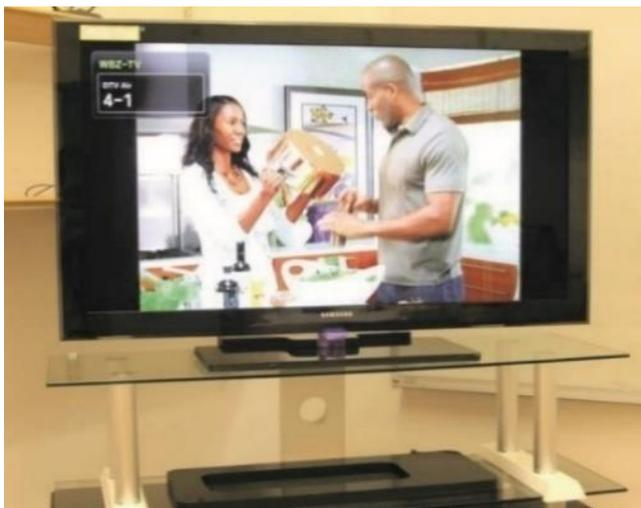
Figure 33: Télévision à écran LCD (~ 250 W)
