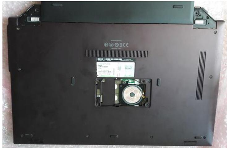
Figure 16:Laptop équipé par un récepteur TESF
