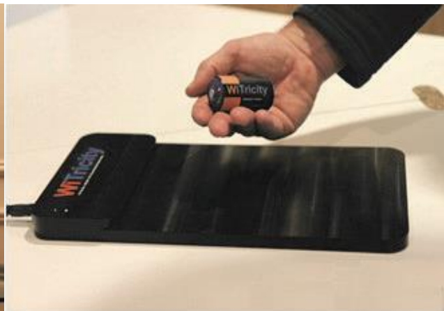
Figure 37: Batterie D-Cell form avec la recharge sans fil intégrée
