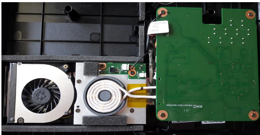
Figure 18:Emetteur TESF avec bobine d'émission assurant la charge du laptop sans fil
