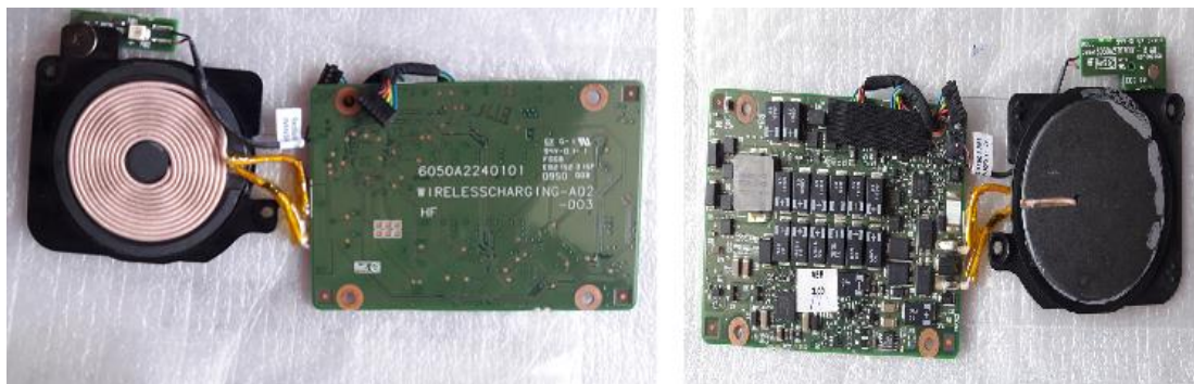
Figure 17:Recepteur TESF de face et d'autre inséré à l'intérieur du laptop
