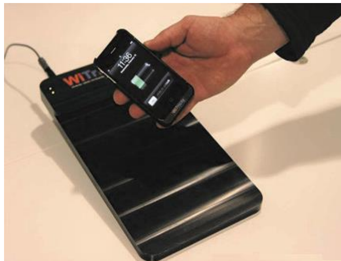
Figure 34: Recharger sans fil une batterie d'un portable (~ 5 W)
