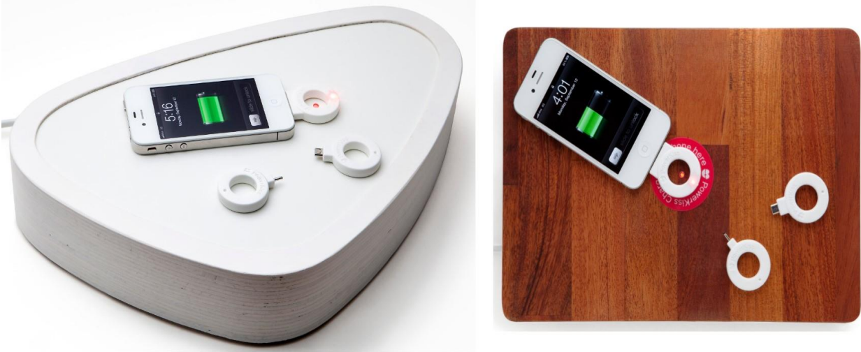
Figure 6: Système de recharge par induction de téléphone portable
