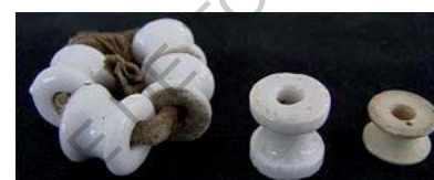
Figure 48: Exemple de support pour fils torsadés en porcelaine. A droite, un taquer en os.
