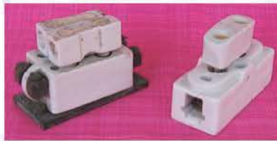
Figure 28: Fusible et porte fusible en porcelaine de 1919.
