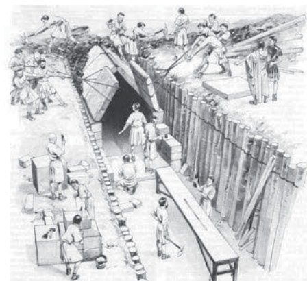
Figure 63: Illustration du principe de construction d'un aqueduc.
