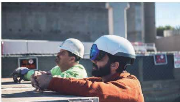
Image 46 – La RA dans un casque de chantier
