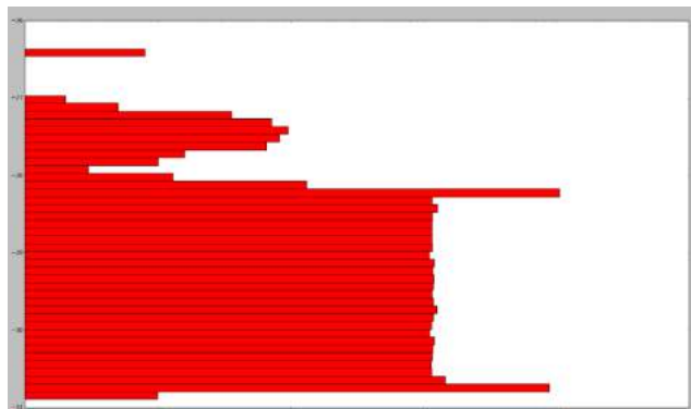
Figure 14 : Histogramme de la densité de point (abscisse) en fonction de la hauteur (ordonnée)
