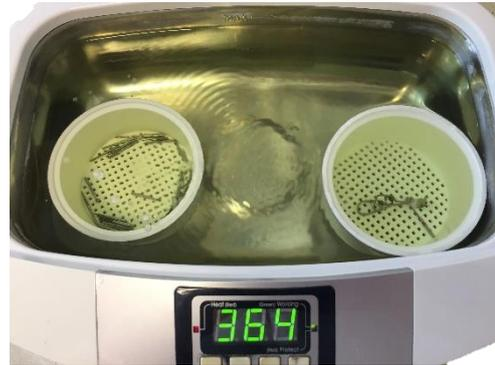
FIGURE 3 : EXEMPLE DE BAC A ULTRASON EN FONCTIONNEMENT (SOURCE PERSONNELLE)
