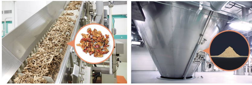
FIGURE 18 : ÉTAPES DE DÉCOUPE ET DE PULVÉRISATION RÉALISÉES DANS L'USINE D'IBARAKI
