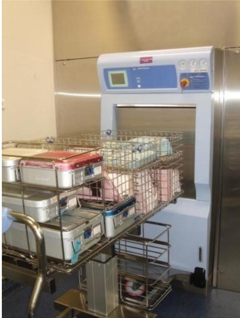
**Figure 12:** Compositions prêtes à être chargées en autoclave
