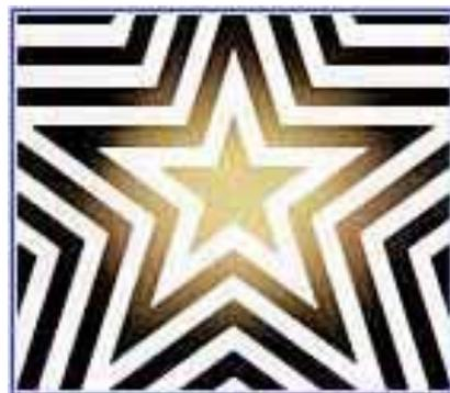
**Figure 14:** Test de Bowie-Dick non conforme
