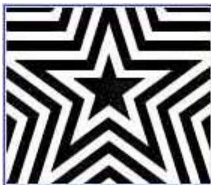
**Figure 15:** Test de Bowie-Dick conforme
