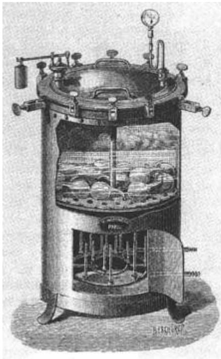
Figure 3: Autoclave Chamberland utilisé pour des travaux de microbiologie (1879)
