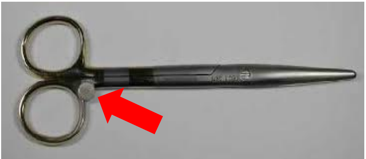
Figure 48: Puce RFID fixée sur un DM
