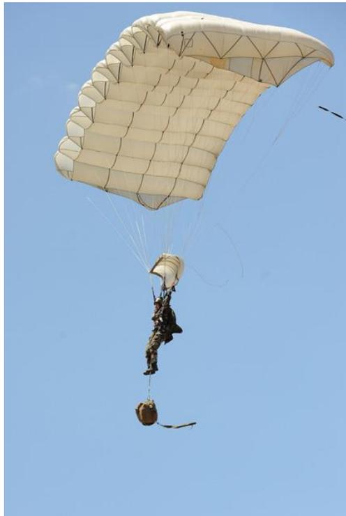
Figure 9 : Parachutiste sous voile avec un parachute à ouverture retardée et gaine.
