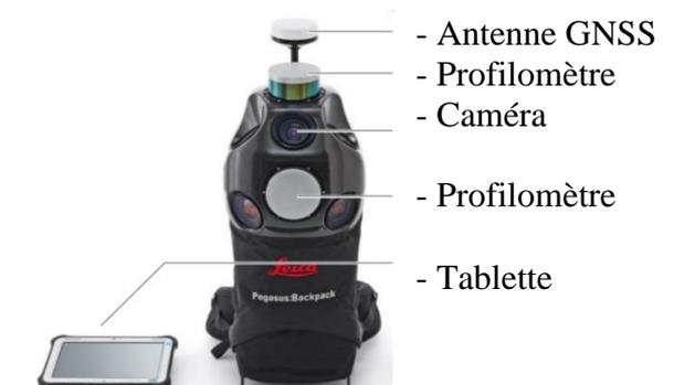
Figure 7 : composition du Backpack, (source : leica.com)
