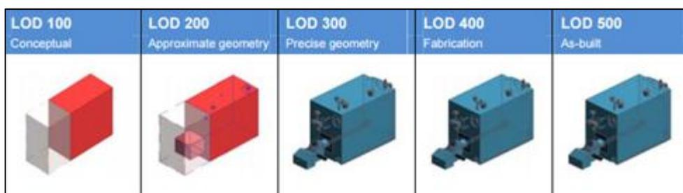
Figure 54 : niveaux de détails d'une maquette numérique BIM (source : objectif-bim.org)
