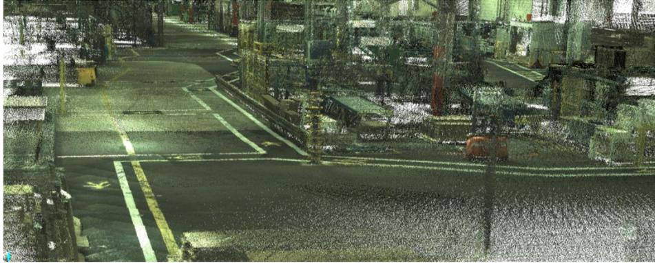
Figure 31 : nuage de points à l'intérieur de l'usine (source : logiciel Pegasus Manager)
