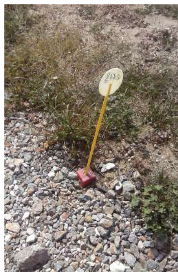
Figure 2 – Photographie d'une borne O.G.E. surplombée par une tigarette jaune (photographie personnelle)
