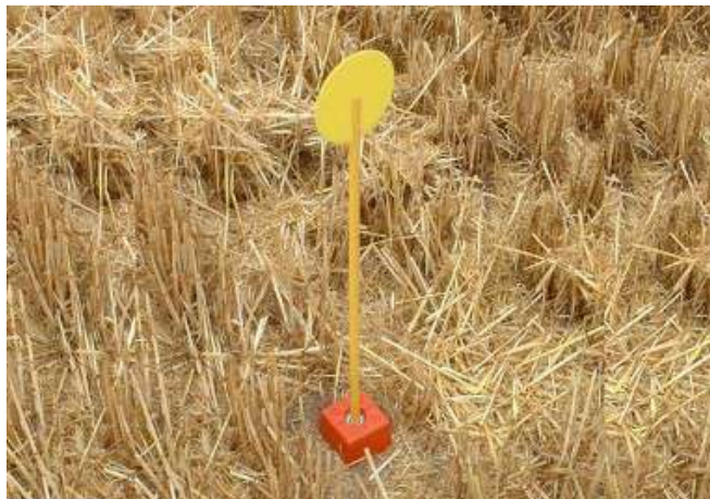
Figure 8 – Exemple de borne à tête polymérisée où sont inscrites les lettres O.G.E., et surmontée d'une tige – Crédit : geofoncier.fr, mars 2017
