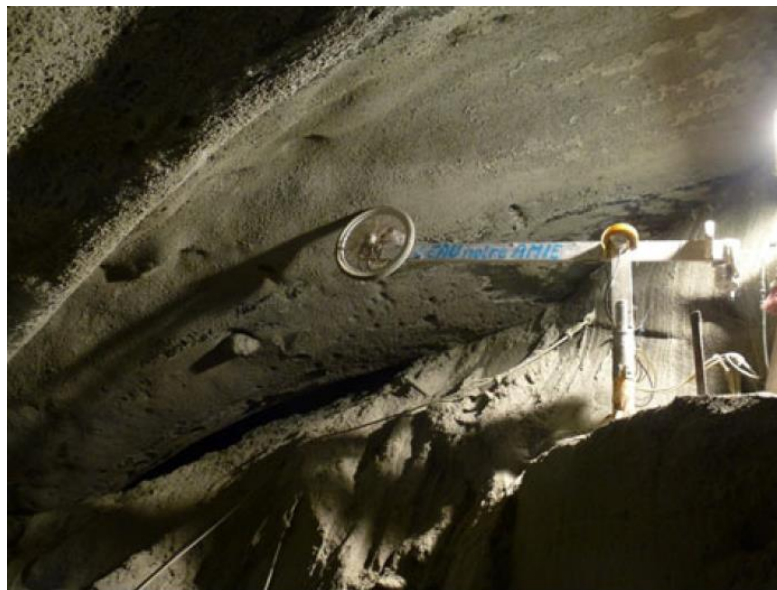
Figure 2 : Cavitomètre situé sous le glacier d'Argentière
