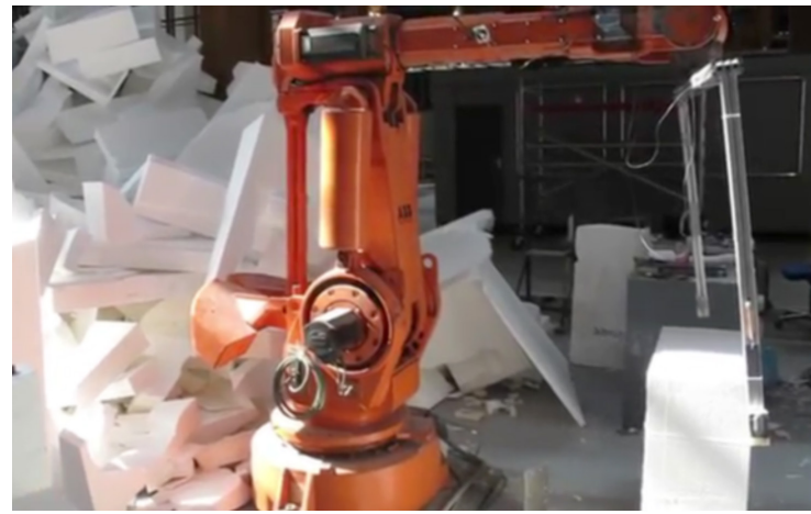
Mode de découpe non perpendiculaire à la surface. La Machine 5 axes découpant les mousses en utilisant un fil chauffé. Le bras est monté sur une machine 5 axes.
