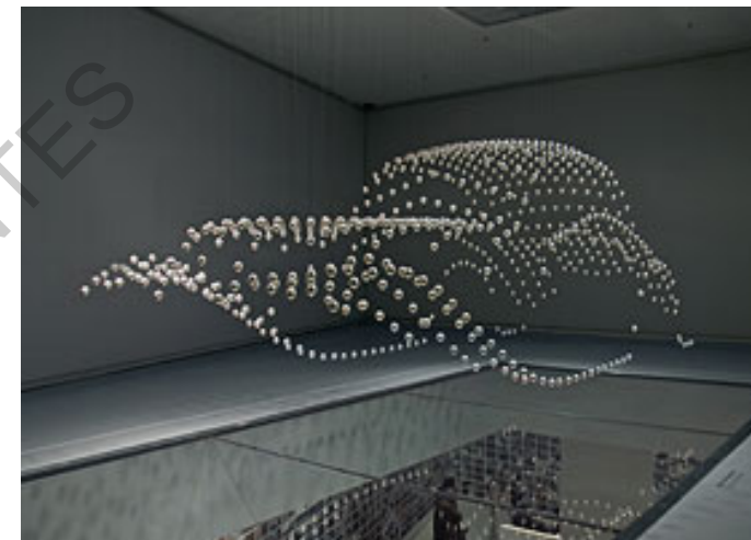
Kinetic Structure au Musée BMW. Scénographie à travers des billes de chrome suspendues contrôlées par des moteurs faisant varier la hauteur de chacune des billes.
