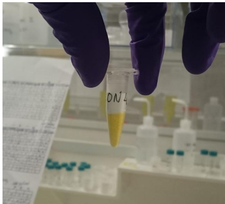
FIGURE 19 : PRECIPITE JAUNE DANS UN TUBE EPPENDORF APRES 2H DE REACTION AVEC DE L'AMMONIUM
