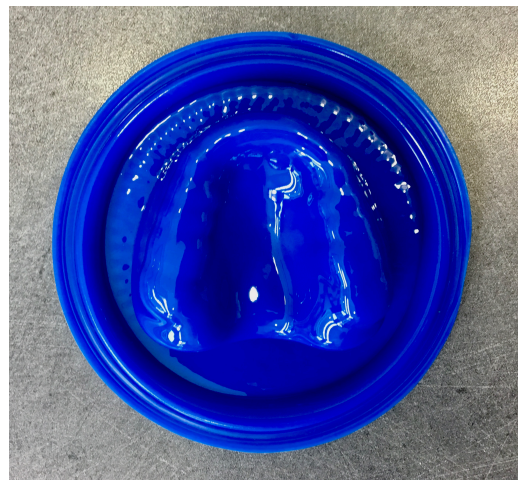
Fig. 4 : Ouverture de la thermoformeuse et PIB obtenue après thermoformage
