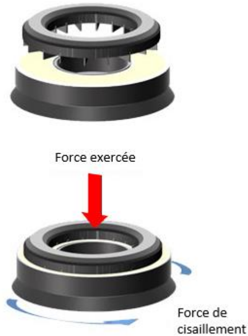
Figure 42 : Principe de réalisation du test de cisaillement avec le FT4 [59]
