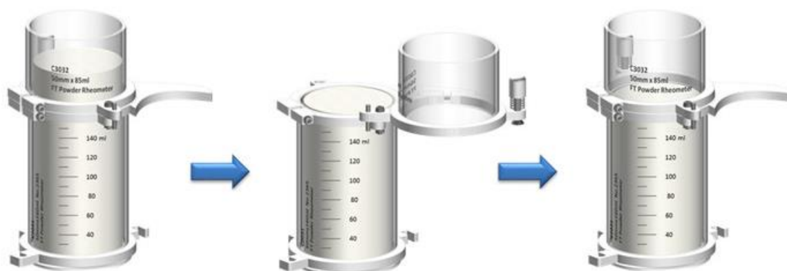
Figure 39 : Principe de mesure de la densité avec le FT4 [59]
