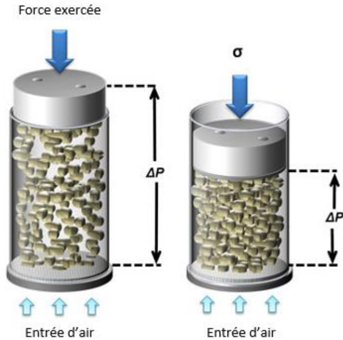
Figure 41 : Principe de mesure de la perméabilité à l'air avec le FT4 [59]
