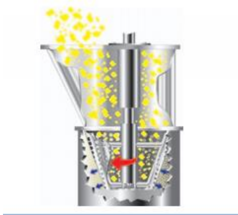
Figure 30: Principe de calibrage dans un calibreur Quadro Comil [44]
