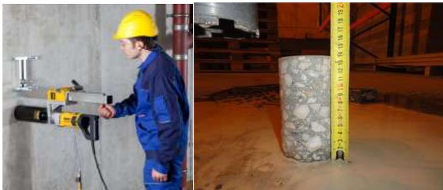
*Figure 2.3.2 : Réalisation d'un carottage et l'échantillon prélevé.*
