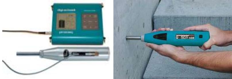
Figure 2.3.3 : Scléromètre et son utilisation sur un béton.
