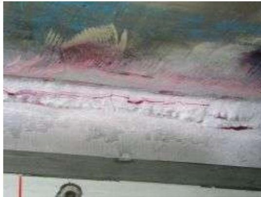
Figure 2.3.6 : Fissures détectées par la méthode de ressuage.
