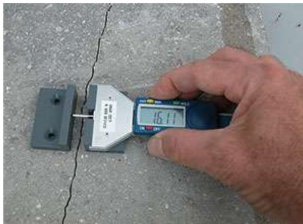
Figure 2.3.7 : Evolution d'une fissure par un fissuromètre.
