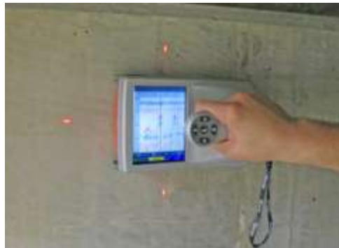
Figure 2.3.4 : Evaluation du béton avec des mesures par ultrasons.
