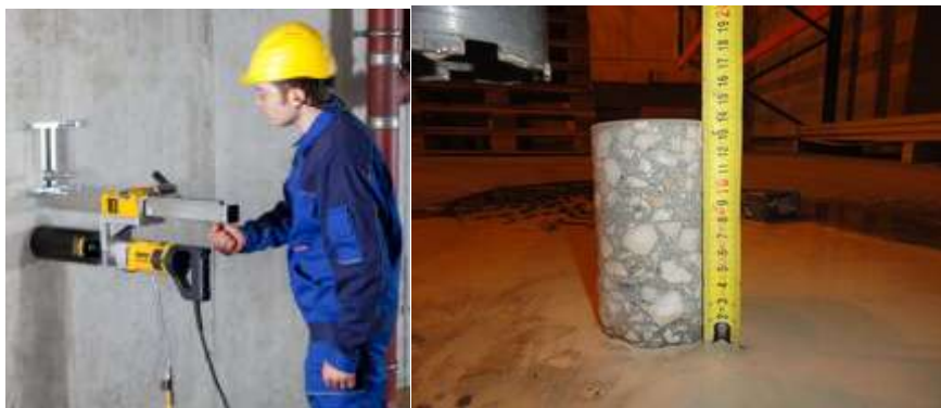
Figure 2.3.2 : Réalisation d'un carottage et l'échantillon prélevé.
