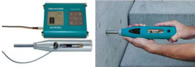
Figure 2.3.3 : Scléromètre et son utilisation sur un béton.
