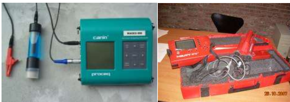
Figure 2.3.5 : Un corrosimètre (à gauche) et un radiographie (à droite).
