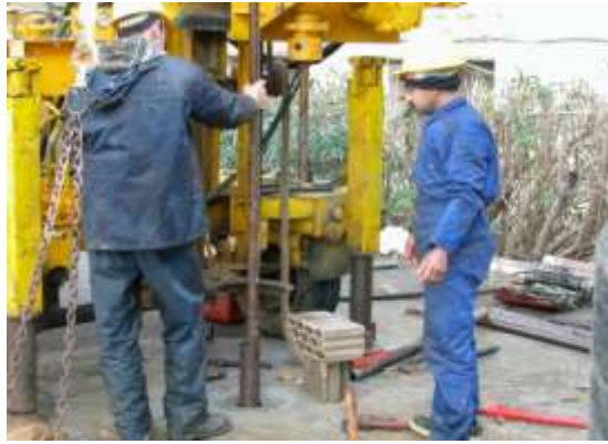
Figure 5.1.10 : Prélèvement d'un échantillon du sol.
