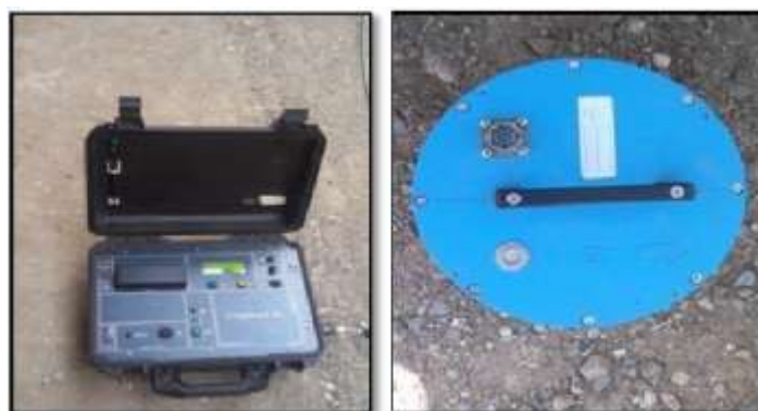
Figure 2.4.1: Appareils utilisés dans la technique de bruit de fond sismique.
