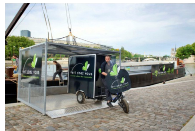
Photographie du déchargement à quai des triporteurs à l'aide d'une grue intégrée Vert chez vous
