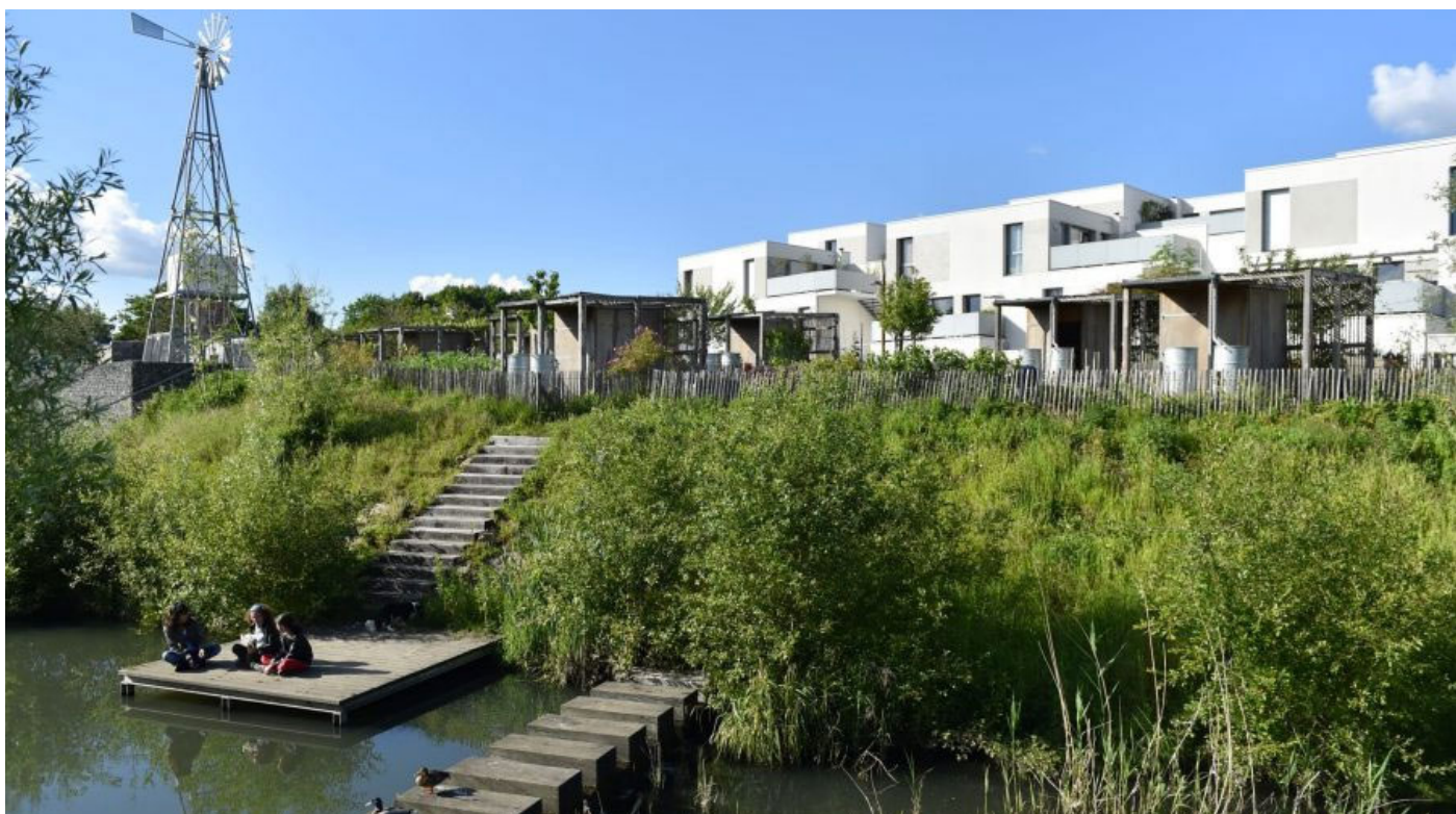
Quartier Bottière Chénaie, Nantes, Atelier de paysages Bruel Delmar : Le ruisseau des Gohards a été réouvert, les eaux pluviales sont collectées dans les fossés qui accompagnent les rues, et dans des bassins qui animent les espaces publics. Des éoliennes hydrauliques concourent à l'arrosage des jardins. © Nantes Métropole Aménagement
