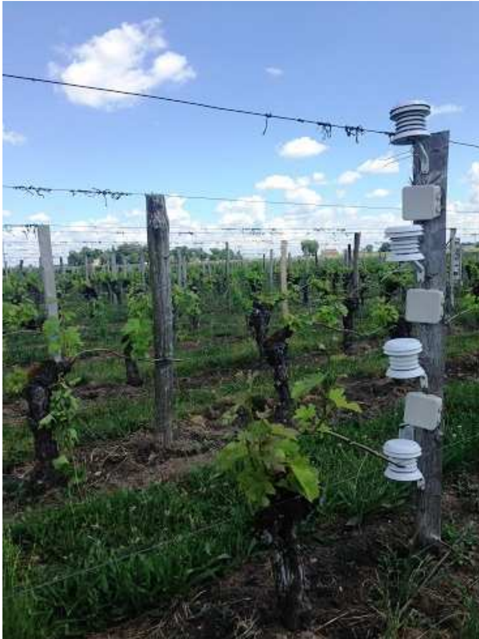
Figure 10 : Piquet de la parcelle 23 enherbée équipé de quatre capteurs de température à 30, 60, 90 et 120cm dans le cadre de l'étude du gradient thermique vertical
