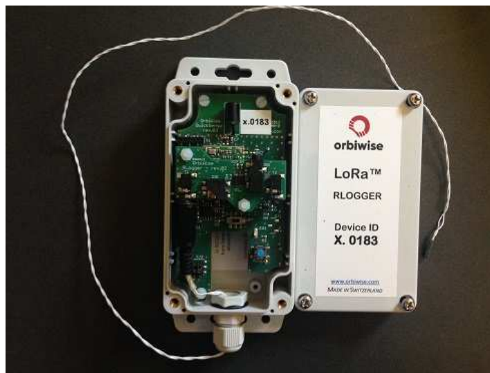
Figure 7 : Intérieur d'un boîtier d'un capteur de température RLogger OrbiWise, équipé d'une sonde de température.
