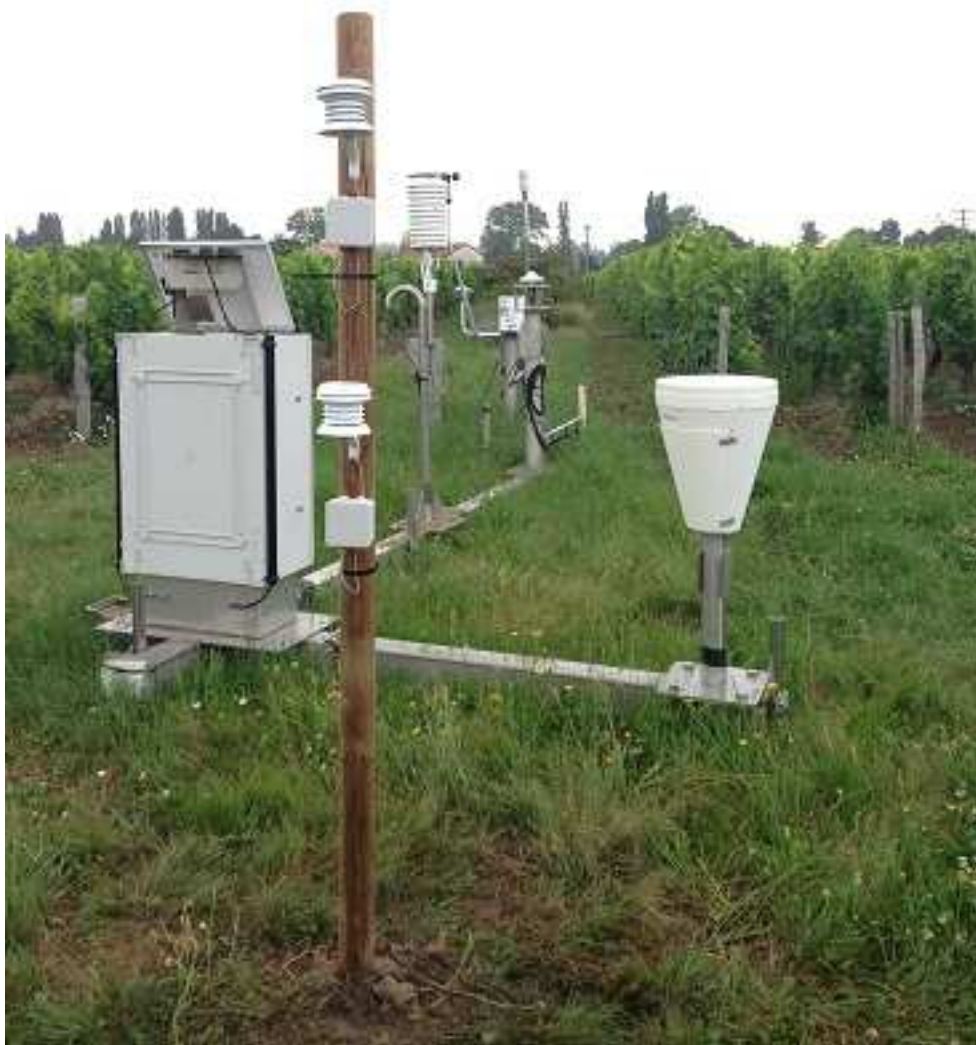
Figure 9 : Dispositif de comparaison de la station Météo-France (second plan) aux capteurs de température (premier plan) localisés à 120cm et 175cm.
