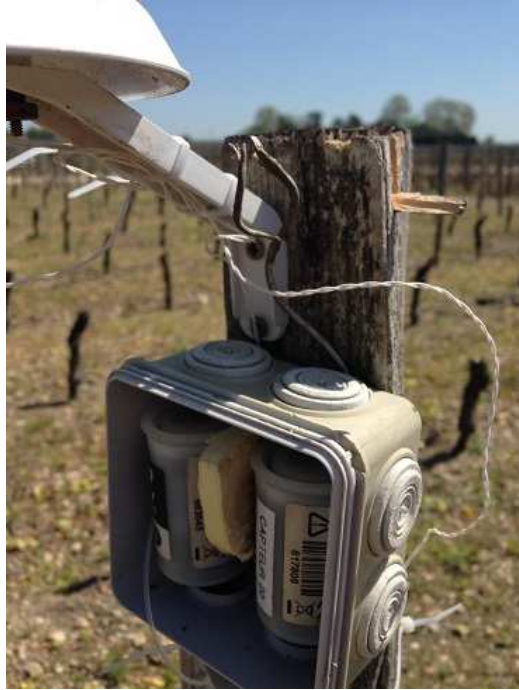
Figure 8 : Intérieur d'un boîtier d'un capteur de température TinyTag Talk 2 équipé de deux sondes de température.
