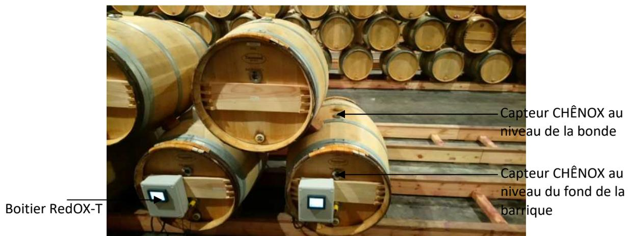
Figure 14: Photo de barriques avec leurs différents capteurs
