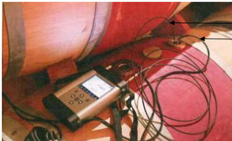
Annexe 4: Photo d'un boîtier mesurant l'oxygène dissous par oxo-luminescence
