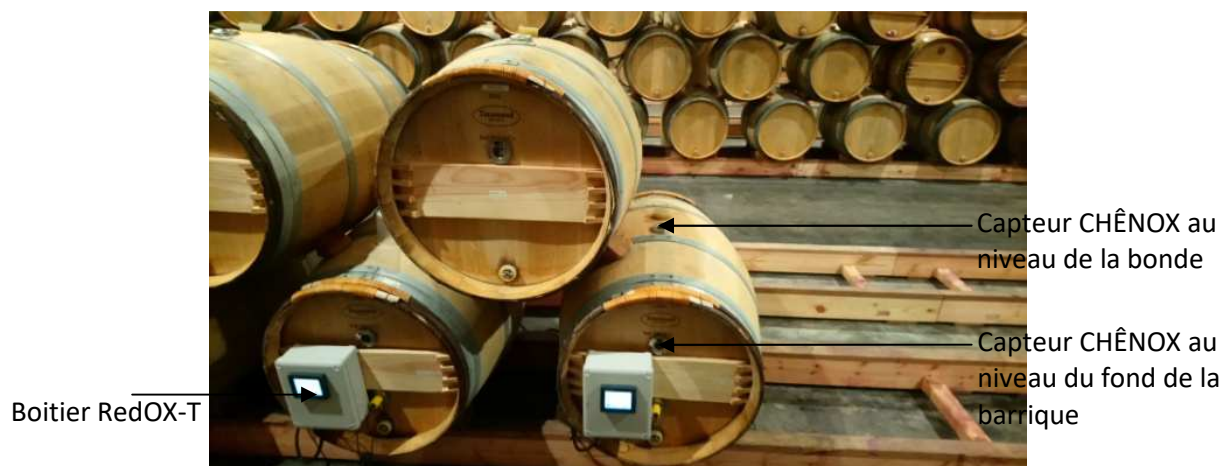
Figure 14: Photo de barriques avec leurs différents capteurs
