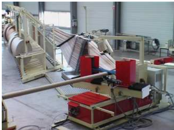
Figure 6 - Fabrication des tubes par une spiraleuse
