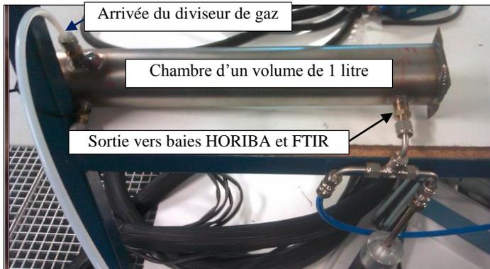
Figure 56 : chambre de sortie montée entre analyseurs et diviseur
