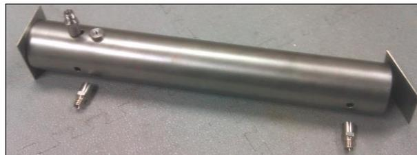
Figure 55 : chambre avant soudage des éléments
