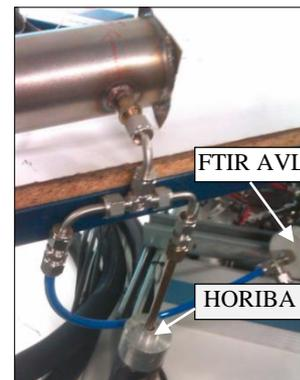
Figure 57 : détail du point de prélèvement
