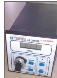
Figure 20 : boîtier de commande manuel des débitmètres (FM2000)
