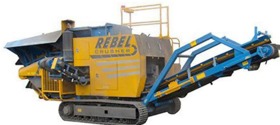
Fig.10 - Concasseur-cribleur mobile pouvant être amené sur chantier -
