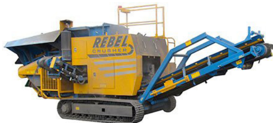
Fig.10 - Concasseur-cribleur mobile pouvant être amené sur chantier - Source : (RDS France, 2018)
