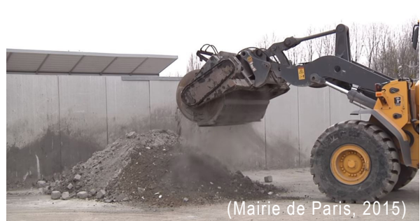
Décrochage à l'aide de tambours mécanisés montés sur le bras articulé d'une chargeuse hydraulique
