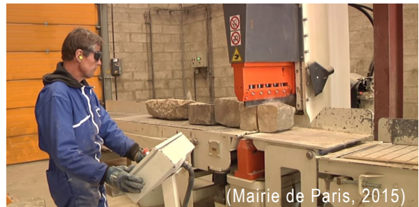
Atelier de fendage (débiteuse à granit, éclateuse) des matériaux modulaire en pierre naturelle
