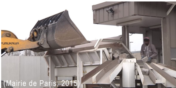
Tri des pavés selon le module ou le type de pavé
