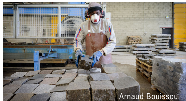
Mise en palette des pavés prêts au réemploi
