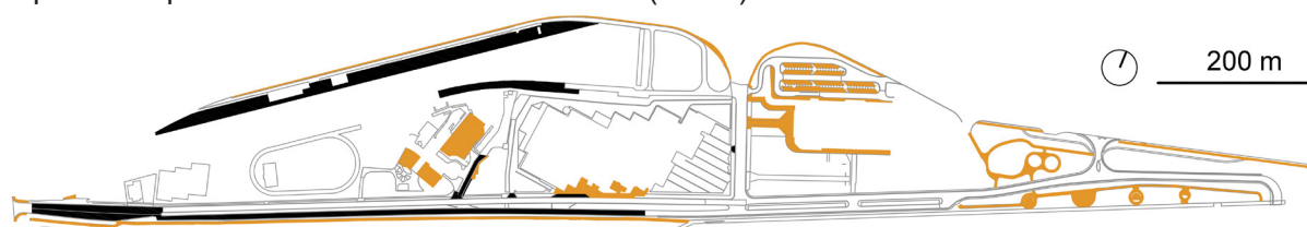
Fig.22 - Plan masse de la localisation des pavés en pierre naturelle (noir) et en béton (orange) sur le site de Coronmeuse à Liège - Source : (Sorre, 2018)
