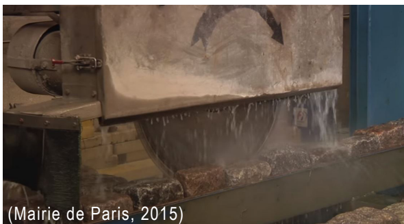
Sciage des pavés à la scie circulaire à eau
