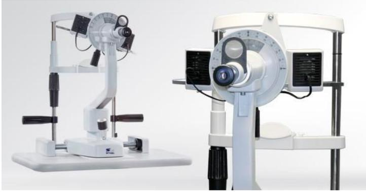
Figure 8 : kératomètre de Javal
