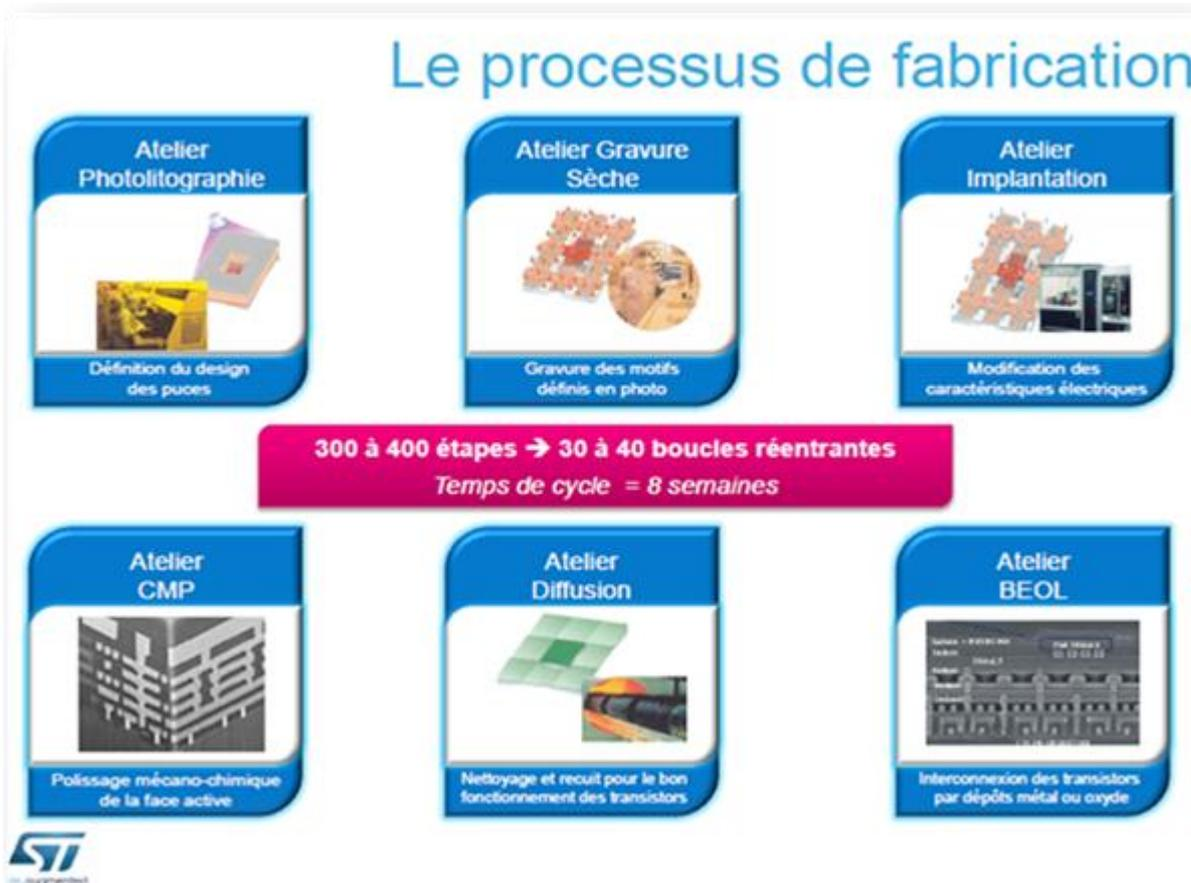
**Figure 1 : Etapes de fabrication des puces**
