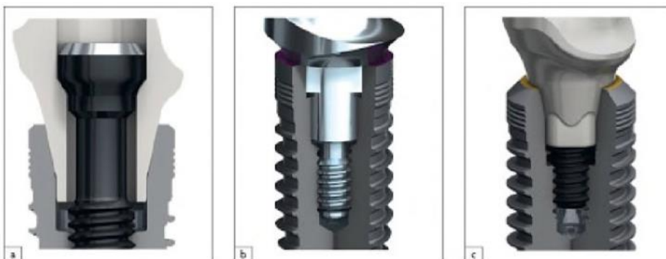
Figure 9 : Différents implants avec une connexion "Platform-Switching"
