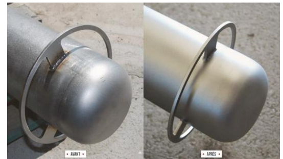
FIGURE 12 DECAPAGE D'UNE PIECE EN INOX
