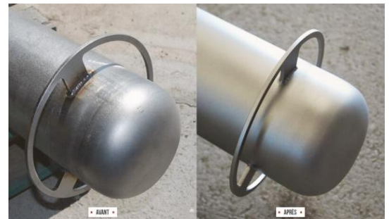
FIGURE 12 DECAPAGE D'UNE PIECE EN INOX
